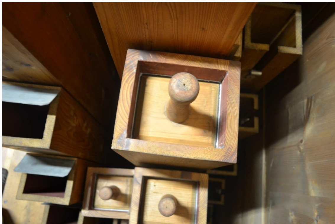
Slika 12: Piščali Borduna 16' s I. manuala, že restavrirane (foto: Brane Košir)
